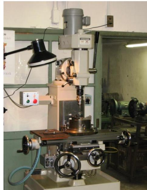
図5 縦型フライス盤の例
