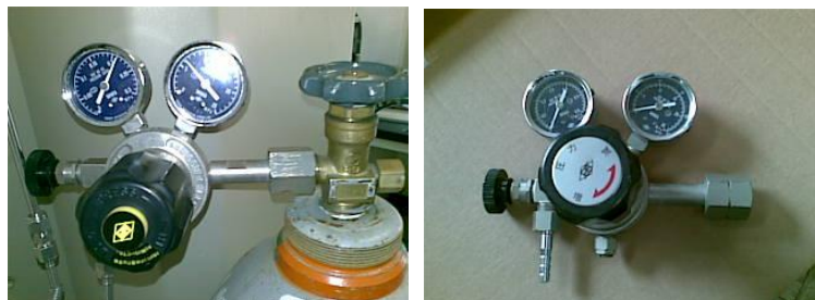
図 2. 窒素ガス用減圧弁(左)とヘリウムガス用減圧弁(右). ヘリウム用の減圧弁入口は逆ねじであることを示す筋が彫ってある。
