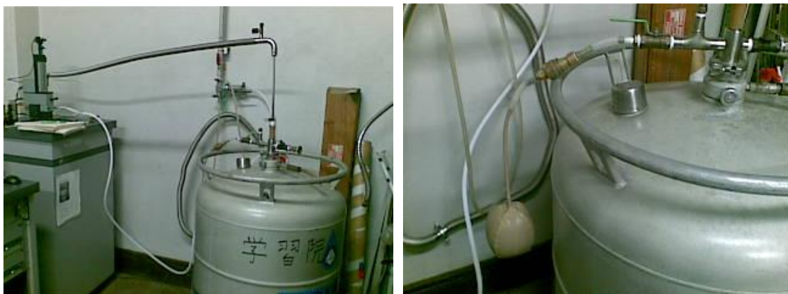
図 6. 液化ヘリウムを装置に転送している場面. 右図の風船によって容器の圧力を上昇させ装置側に送っている。
