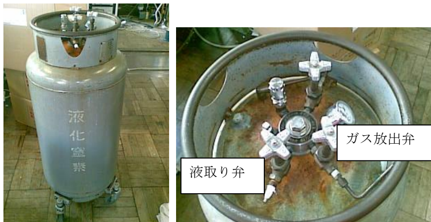
図 5. 高橋研で使用している 100L セルファー。液を取り出す場合、
