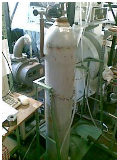
図1 高橋研で使用している7 m 3 ヘリウムガスボンベ
